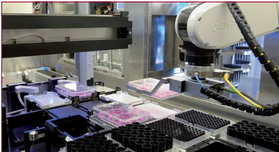
die alle Abläufe kontrolliert und adaptiv auf diese reagieren kann, wie zum Beispiel beim Wachstum der Zellen.“ Über eine intuitive Benutzeroberfläche lassen sich die zur Verfügung stehenden Dienste steuern oder zu beliebigen, komplexen Abläufen zusammenstellen. So sind für den User alle Geräte (Mikroskop, Denso VS-087, Liquid Handling Unit, Inkubator, verschiedene Magazine) – über eine grafische Benutzeroberfläche steuerbar. Die Software ist in C# geschrieben.
