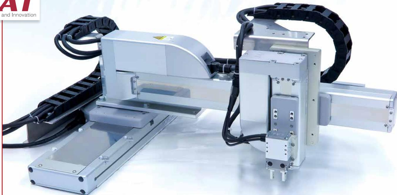
Der kartesische Roboter aus dem Hause IAI ist als vierachsiges System komplett mit elektrischem Greifer ausgelegt
