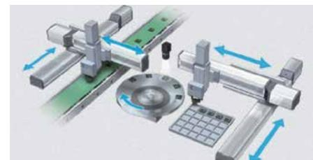
Pick & Place von Werkstücken, z. B. Werkstück-Transfer von Fließband zu Fließband
